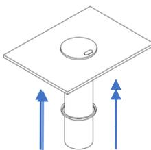
Insira a T. Tower no recorte. Realizar a fixação da através do anel de fixação utilizando os parafusos no móvel.
