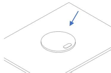
Ligue o cordão de alimentação da T. Tower na rede elétrica da instalação. Pressione a T. Tower para movimentar. Após o acionamento da T. Tower todas as tecnologias da mesma, como tomadas elétricas, carregador Qi, portas USB A e C estarão prontas para uso.
