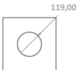
Faça um corte redondo no móvel com diâmetro de 119mm.
