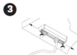
Após encaixado no recorte, afaste os parafusos em direção as extremidades da peça para fixação.
