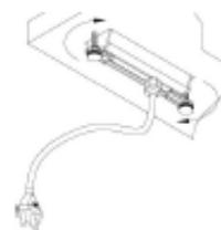
Aperte os parafusos até que a peça esteja firme na superfície e ligue Axil Z à tomada.
