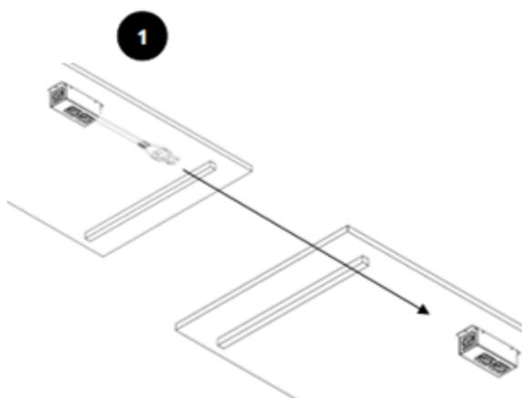
Insira a Fit Connect na superfície onde será aplicada e fixe os parafusos nas extremidades da Fit Connect. Após fixar, ligue-a na tomada e conseqüentemente nas demais Fit Connect.
