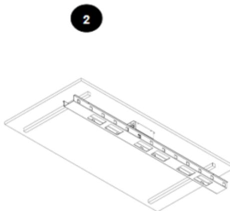
Após fixar e montar o sistema Fit Connect, fixe a Fit Trail, lembrando de colocar todo o cabeamento existente dentro da calha, para que nenhum cabo fique solto.
